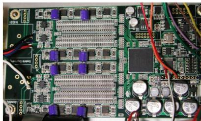
以前は PCM 信号をハードで DSD 変換して再生する DAC を使っていましたが、最近は初心? に帰ってマルチビット DAC を使っています。
