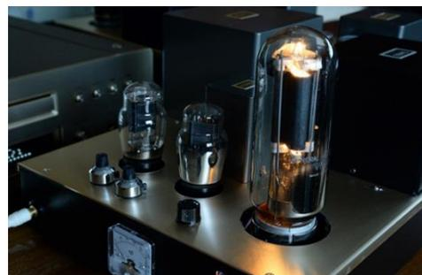
56.6mAくらい流れています。ハムバランス V R 10 Ω 両側に50 Ω 抵抗を直列にいれています。電流計では56mA位の指示です。1000V以上かけて、バイアスをもっと浅くして60mA以上流せばと思いますが、怖いのでやっていません。
